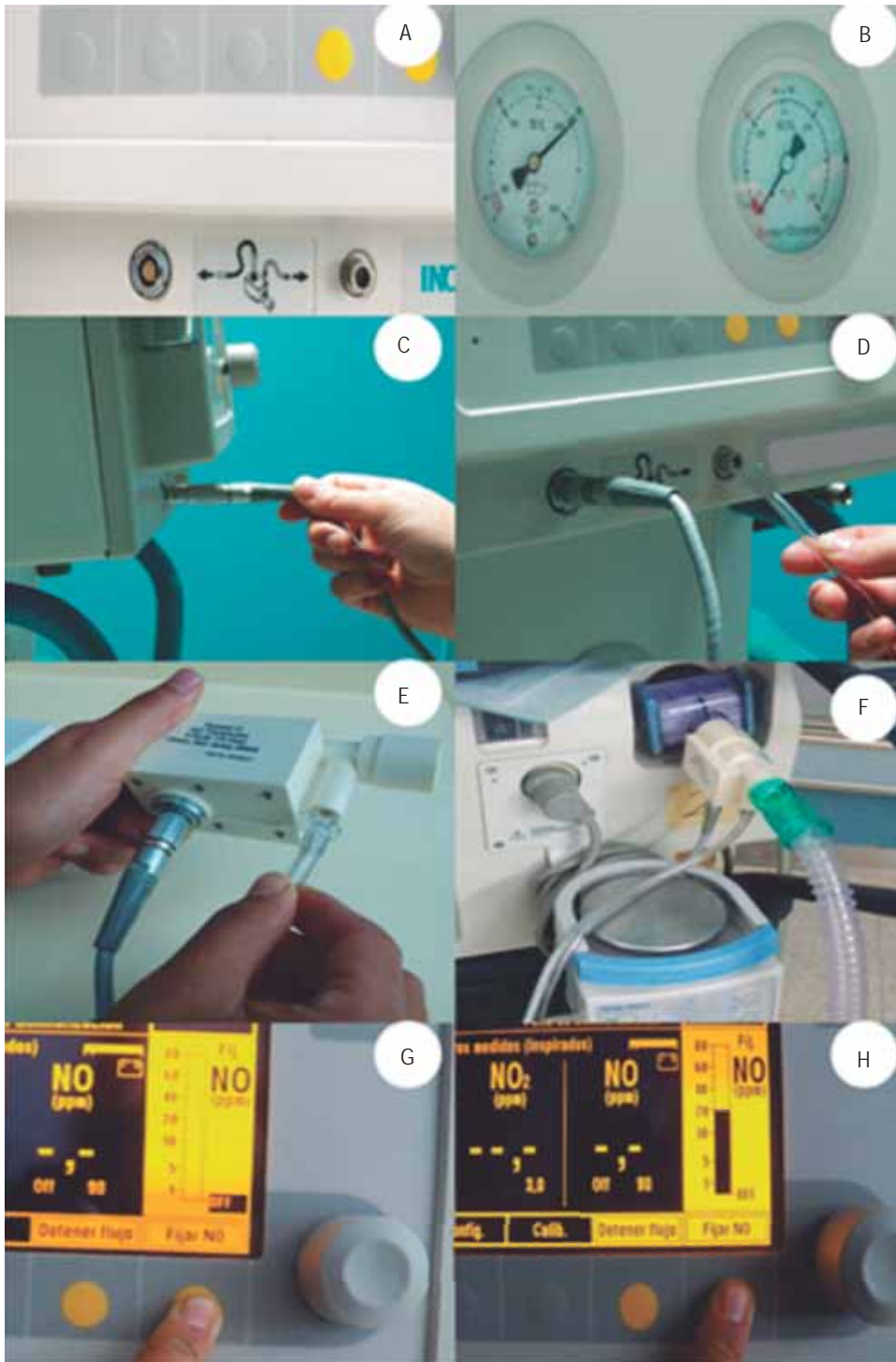
Figura 2. Conexión del sistema de inyección: A. Reconozca los adaptadores del cable electrónico y de la extensión plástica de la inyección, B. Corrobore que el manómetro ofrezca al menos 2,000 psi de óxido nítrico, C. Adapte el cable electrónico al módulo de inyección, D. Adapte la extensión plástica al módulo de inyección, E. Adapte el cable electrónico y la extensión plástica al tubo inyector, F. Instale el tubo inyector en el origen de la vía inspiratoria del equipo de asistencia mecánica ventilatoria, G. Encienda el módulo de inyección y H. Oprima el botón fijar dosis y con la perilla programe la cantidad de óxido nítrico deseado.
